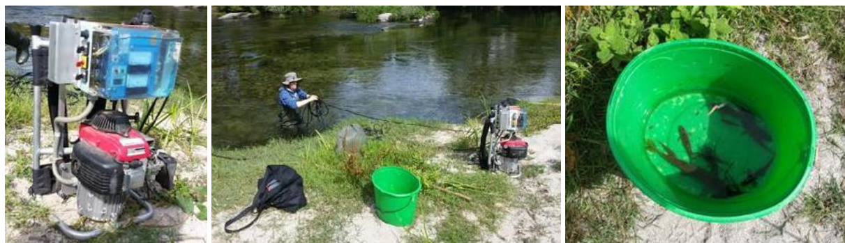
Figura 4 – Equipamento de pesca eléctrica utilizado nas amostragens (esq.), amostragem por pesca eléctrica (centro) e amostras recolhidas para análise laboratorial (dir.).
